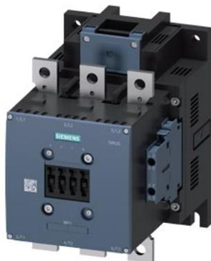
Силовой контактор, AC-3 265 A, 132 кВт/400 В AC (50–60 Гц)/режим работы по DC UC 220–240 В Вспомогательные контакты 2 НО + 2 НЗ 3-полюсн., типоразмер S10, шинные соединения Привод: стандартный винтовой зажим
